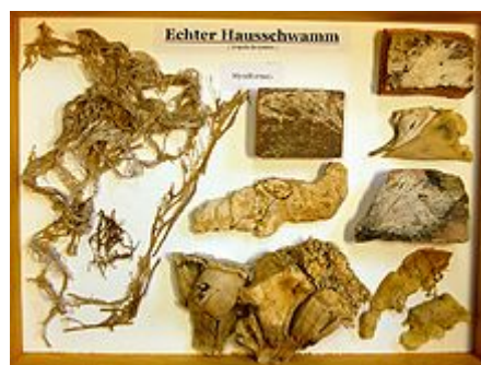
Schadbilder des Echten Hausschwamms
